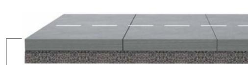
**Bei Neubau:** Widerstandsfähiger als Asphalt sind **Betonplatten**. Diese müssen aber regelmäßig neu verfügt werden; Einsatz besonders auf viel befahrenen Routen
